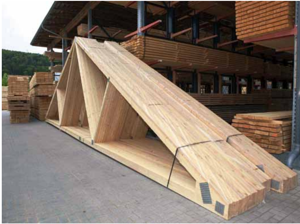
Nagelplattenbinder werden mit maschineller Unterstützung vorgefertigt, per Lkw zur Baustelle transportiert und dort exakt nach Plan montiert.
