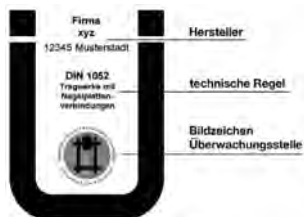
2 | Das Ü-Zeichen für Nagelplattenbinder mit den erforderlichen Angaben
