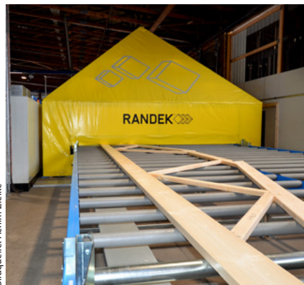
Vollautomatische Produktion von Nagelplattenbindern bei Schnoor
