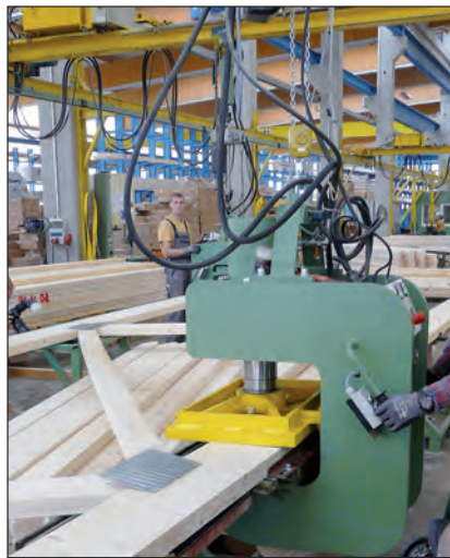
Mittels Kran geführte C-Pressen für die punktuelle Knotenverpressung hoher Nagelplatten-Binderkonstruktionen.
