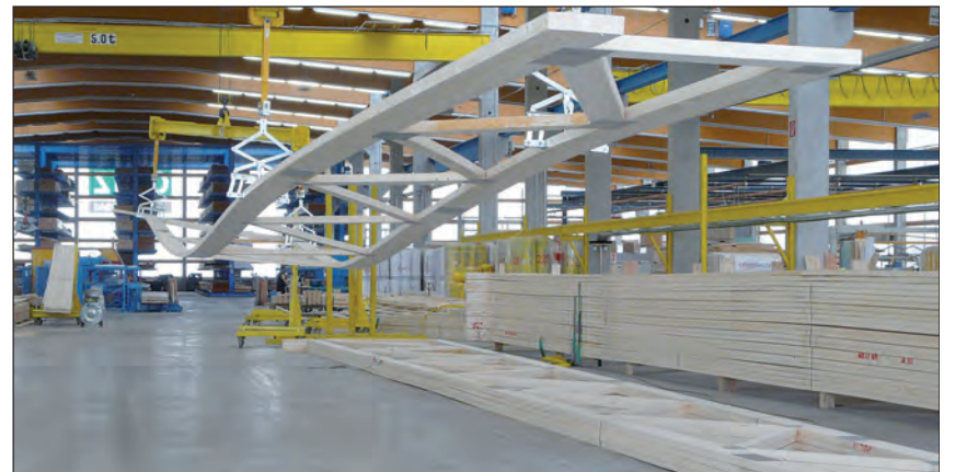
Biegsam und doch hoch tragfähig: Binder-Handling in der Halle der lichtdurchfluteten Opitz-„Zukunftsfabrik“ in Neuruppin. Fotos: L. Pirson, Nuding (1)
