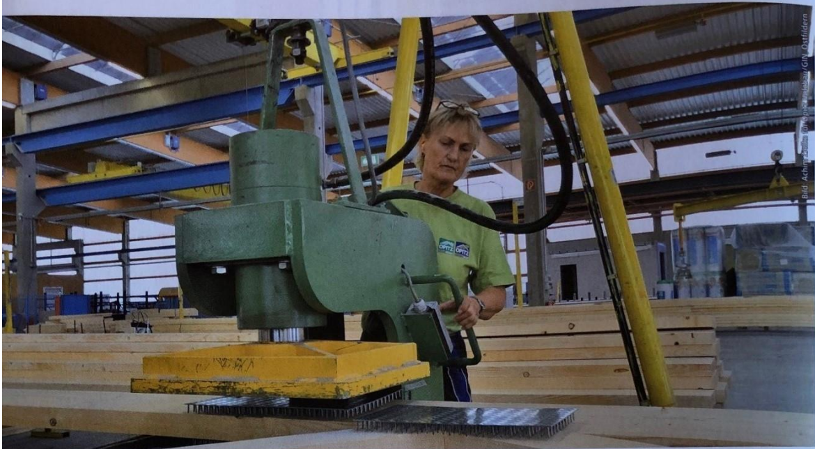
Fünf C-Pressen sind bei Opitz Holzbau einsatzbereit, um Holzgurte und -stäbe mittels Nagelplatten zu verbinden. Mit bis zu 25 bar Druck kann Bianca Bäker damit auch großformatige Nagelplatten beidseits im Holz verankern.
