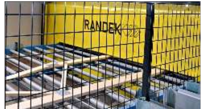
Presszelt der „Autoeye“-Anlage von Randek: Die Anlage kann pro Tag mehrere hundert Nagelplattenbinder produzieren. Die ins Holz gepressten Nagelplatten liefert Mitek Industries. Fotos: A. Zielke (4)
