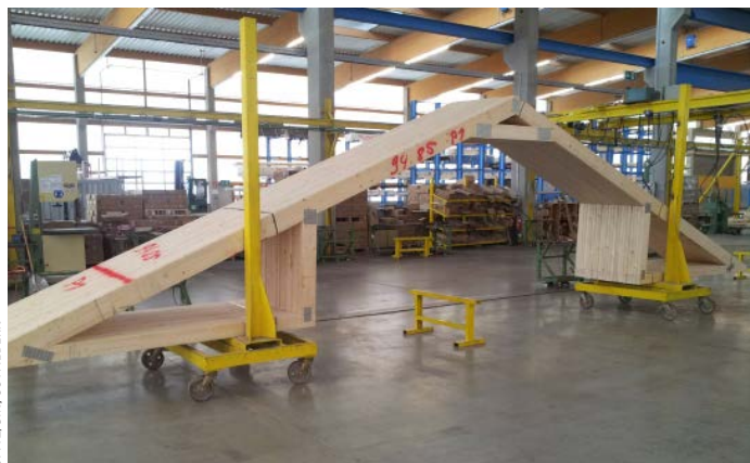
Hier werden Studiobinder in der Halle vorgefertigt
