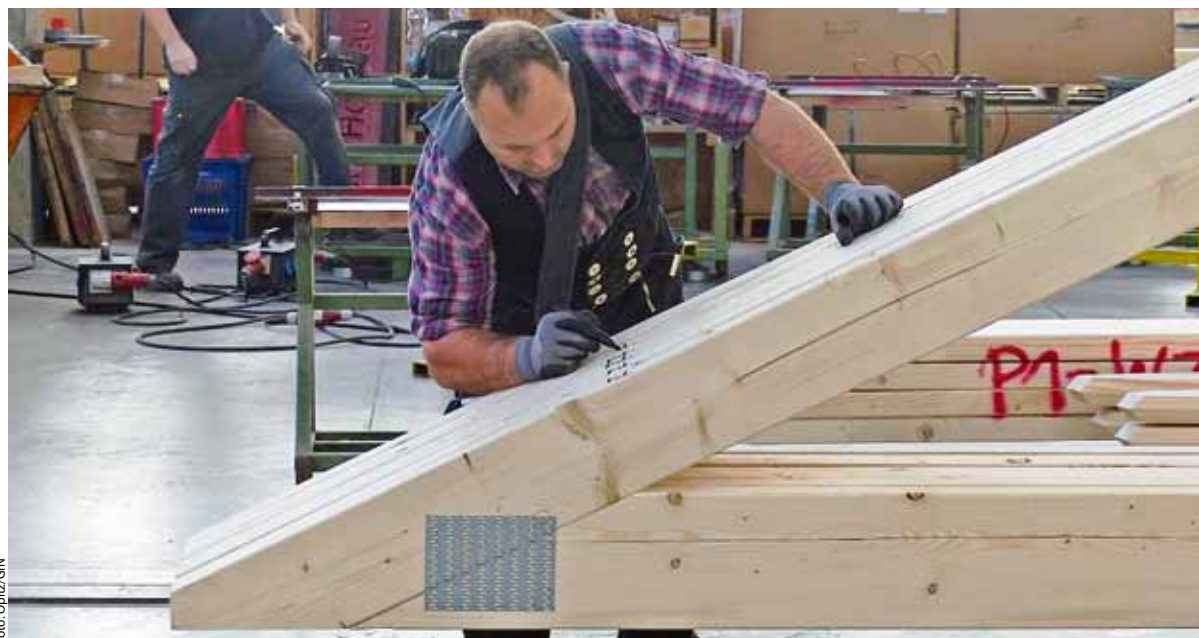
Jeder einzelne Nagelplattenbinder wird unmittelbar nach der Herstellung im Werk nummeriert. Seine genaue Position auf den Umfassungswänden des Gebäudes ergibt sich aus der Tragwerksplanung, die bei der Produktion inklusive statischer Bemessung vorliegt.
